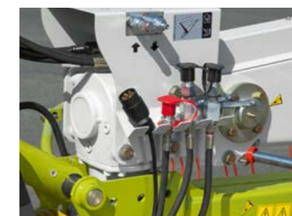
Vakiovarusteena etu- ja takarottorin hydraulinen jakso-ohjaus nostettaessa ja laskettaessa.
