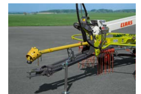
LINER 700 TWIN voidaan lisävarustaa suunnikkaisvetolaitteella, LINER 800 TWIN -mallissa se on vakiona.
