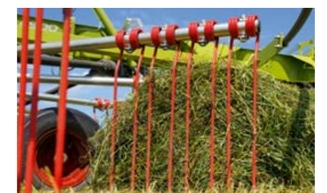
Säilörehupiikit hellävaraisen rehun siirtoon
