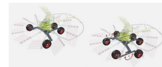
Ihanteellinen piikkien ohjaus: siitä huolehtii roottorialusta, joka on sijoitettu mahdollisimman lähelle roottorin piikkikehää.
