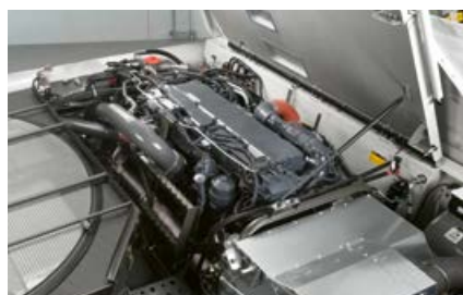
TRION 760 ja 750 malleissa on tehokas, 6-sylinterinen, 507 hv:n ja tilavuudeltaan 12,4 litran MAN moottori.
