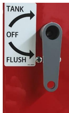
Kuva 2. Venttiili asetettu huuhtelua varten
