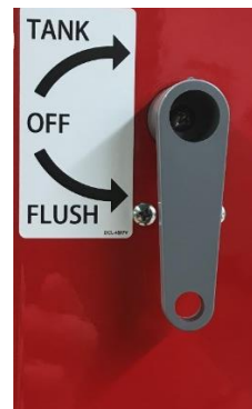
Kuva 2. Venttiili asetettu huuhtelua varten
