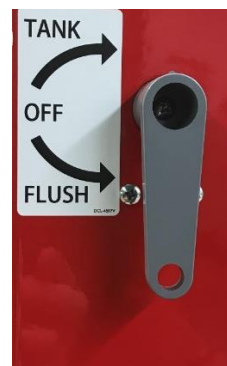
Kuva 2. Venttiili asetettu huuhtelua varten
